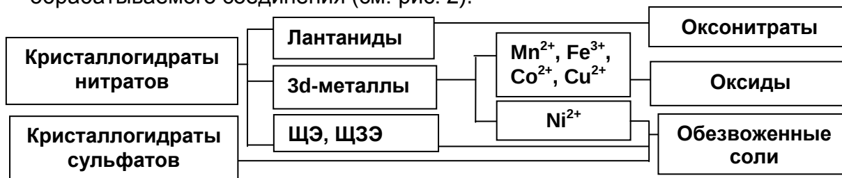
Рис. 2. Состав продуктов, образующихся при микроволновой обработке кристаллогидратов различных солей.
